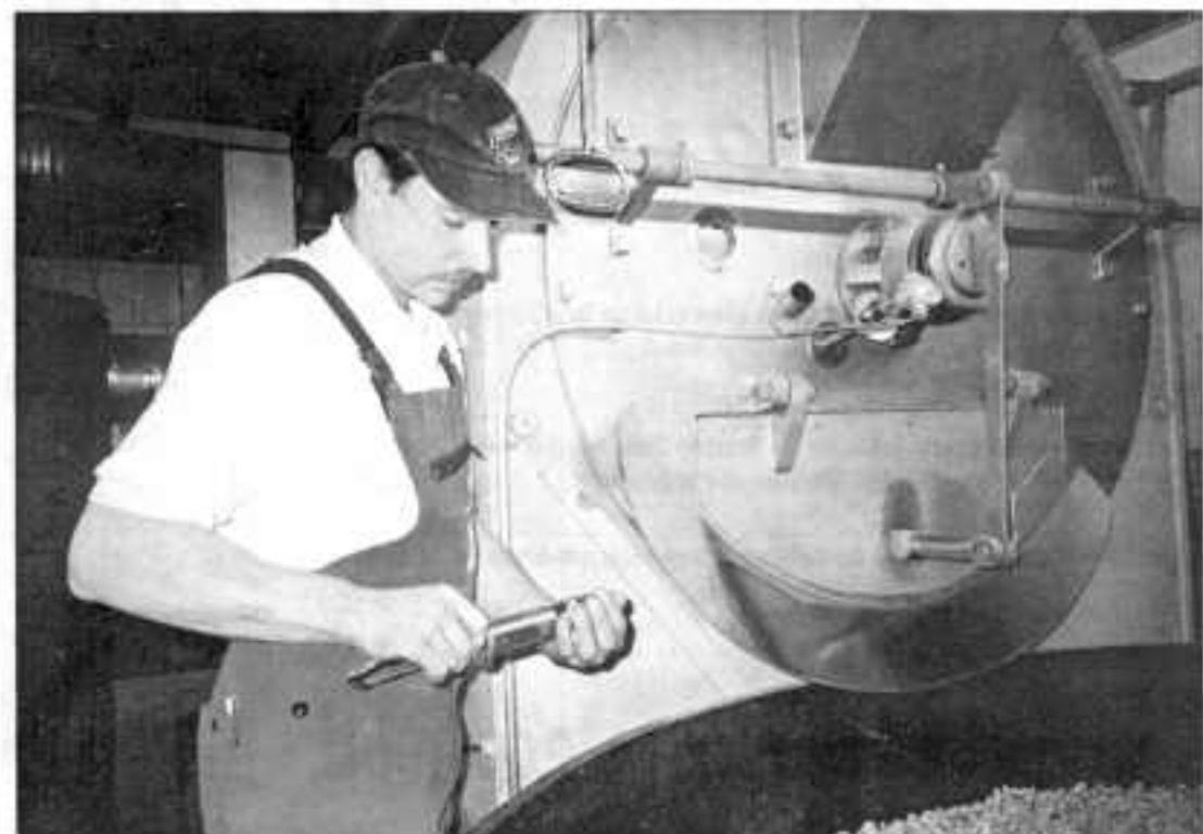
Die Erdnuss wird bei 125 Grad geröstet. Martin kontrolliert, ob der Röstvorgang schon beendet ist.
