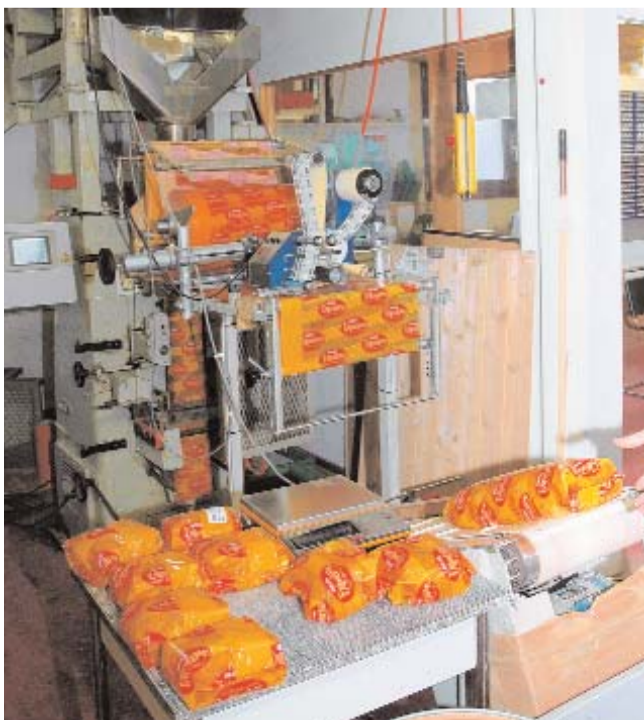
Bis auf wenige nötige Einstellungen durch Menschenhand läuft die Verpackungsmaschine vollautomatisch.
