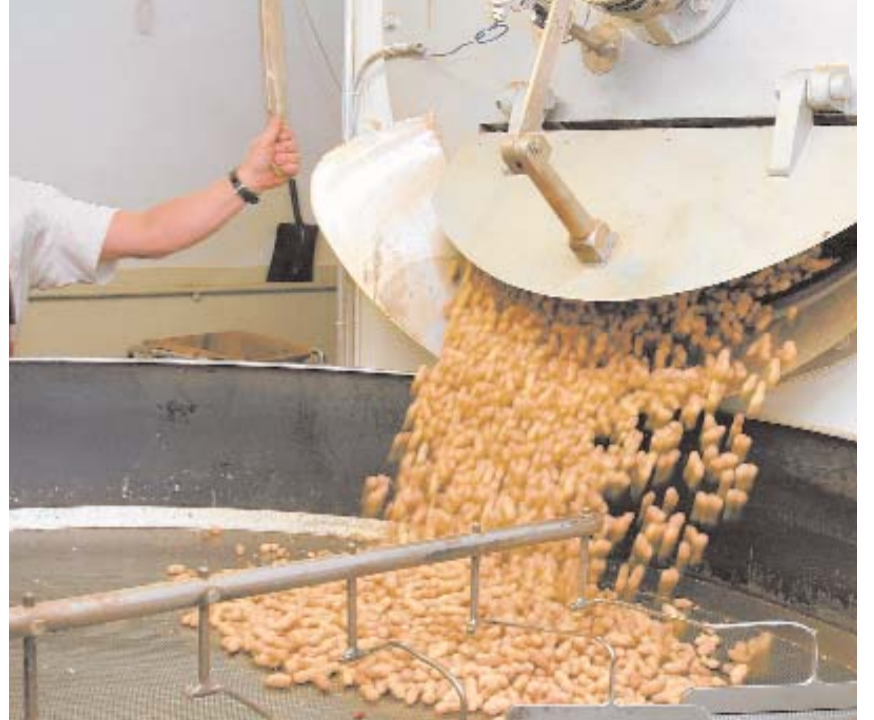
Sobald aus Sursee das Okay eintrifft, dürfen die Erdnüsse im oberen Stockwerk in den Trichter geleert werden, wo sie auf direktem Weg in die Rösttrommel fallen. Nach rund 30-minütigem Rösten sind sie zum Auskühlen bereit.
