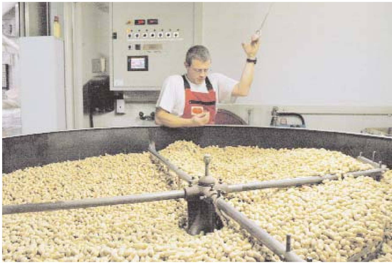
Während die frisch gerösteten, warmen Erdnüsse rund sieben Minuten auskühlen, nimmt Daniel Kündig einen Augenschein und lässt mit seiner linken Hand bereits die nächste Ladung in die Rösttrommel fallen.
