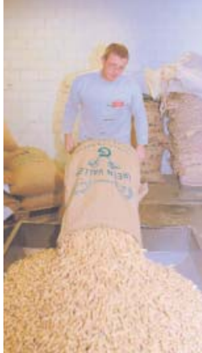
Sobald aus Sursee das Okay eintrifft, dürfen die Erdnüsse im oberen Stockwerk in den Trichter geleert werden, wo sie auf direktem Weg in die Rösttrommel fallen. Nach rund 30-minütigem Rösten sind sie zum Auskühlen bereit.
